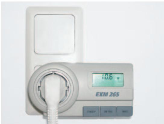
Mit einem einfachen Messgerät kann der Stromverbrauch von Haushaltsgeräten gemessen werden.
