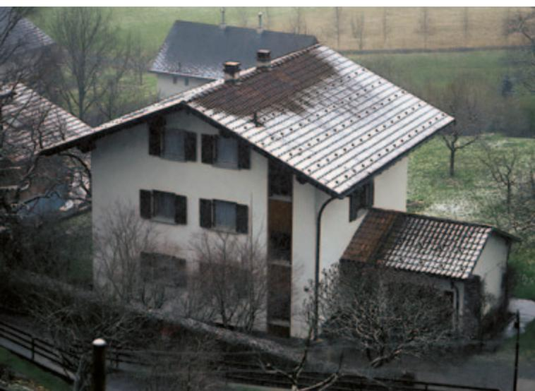
Ungenügend gedämmte Decken zum Dachboden sind für einen Großteil des Wärmeverlustes verantwortlich. Am besten sieht man Wärmeverluste bei Dächern im Winter. Der Schnee schmilzt dort ab, wo viel Wärme verloren geht.
