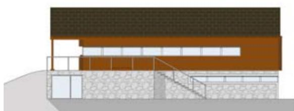
In alto e a destra, progetto di recupero per un tabià in pietra e legno. L'uso di materiali non tipicamente montani quali il calcestruzzo e l'acciaio ha permesso di realizzare due finestre a nastro, una sul sistema ligneo a blockbau e una sul basamento lapideo (progetto Martina Cordella, Giulia Tomaello, Marta Nanut, Elena Spinello).
